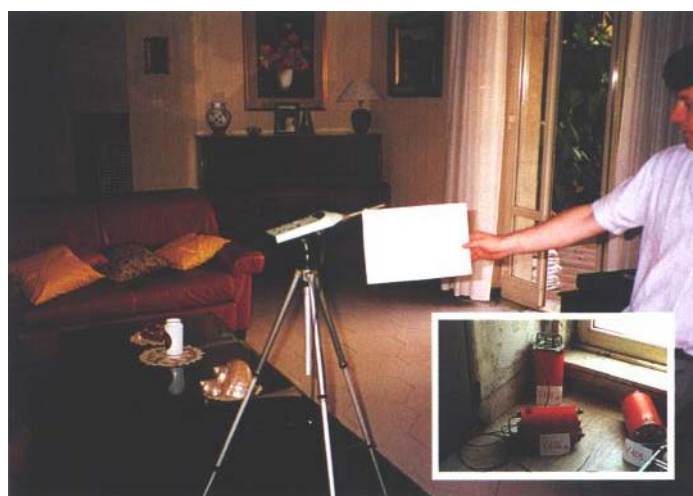
Misurazioni fonometriche e sismometriche in un edificio in prossimità di una linea ferroviaria metropolitana. I sismometri misurano le velocità di vibrazione in tre direzioni ortogonali.
