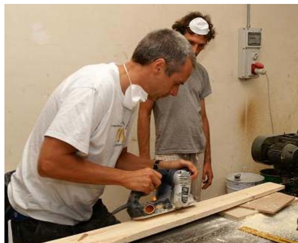
Prima rifinitura con pialletto elettrico.
