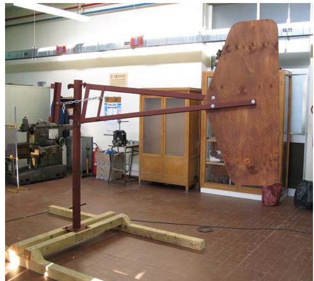
Sull'estremità della coda viene infine fissato il timone in compensato multistrato, preventivamente verniciato con conservante per legno
