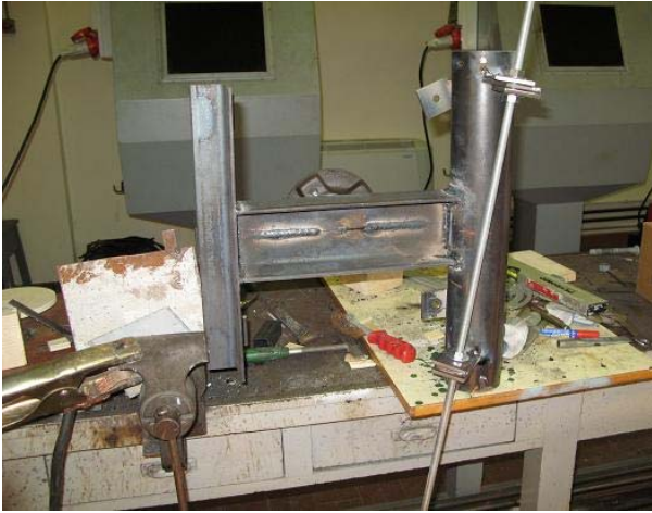
Saldatura dei ganci per il montaggio della coda snodata
