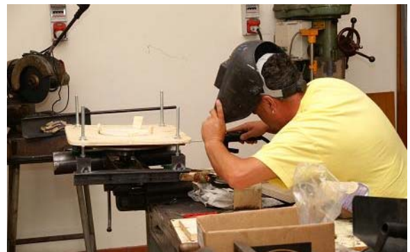
Posizionamento degli angolari di supporto per lo statore, con l'aiuto della sagoma di legno ricavata dalla costruzione dello stampo
