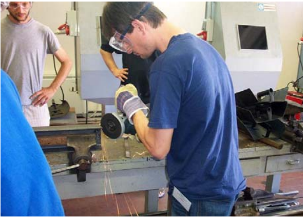
Luca arrotonda il supporto del mozzo per facilitare la saldatura sul tubo di imbardata.
