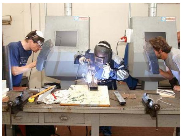
Sergio salda l'asse del mozzo sulla staffa di supporto, osservato da Luca e Nicola, muniti di maschera per saldatori
