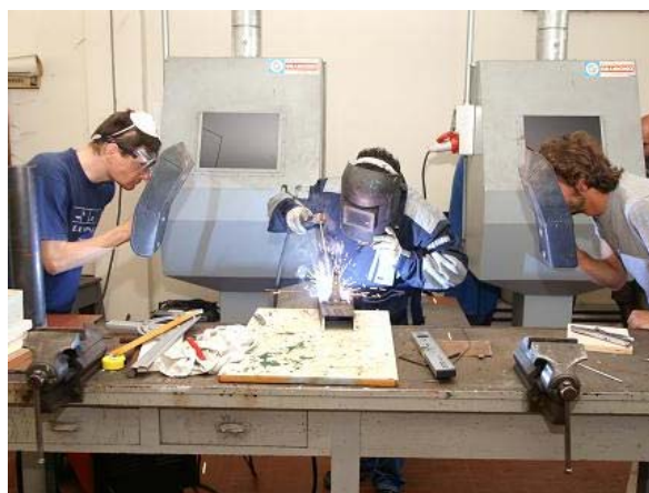
Sergio salda l'asse del mozzo sulla staffa di supporto, osservato da Luca e Nicola, muniti di maschera per saldatori
