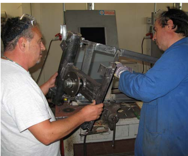
Prova di montaggio della coda sui ganci, per verificare che l'oscillazione non abbia impedimenti.
