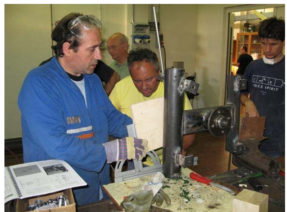
Posizionamento degli angolari di supporto per lo statore, con l'aiuto della sagoma di legno ricavata dalla costruzione dello stampo
