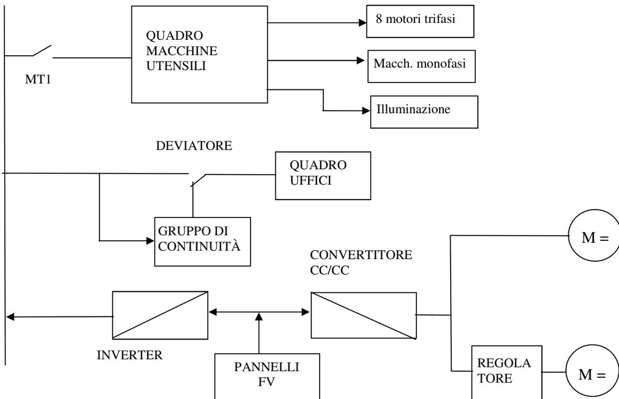
Per la protezione della linea di alimentazione del reparto macchine utensili occorre determinare la corrente totale. Ognuno dei carichi assorbe una corrente
