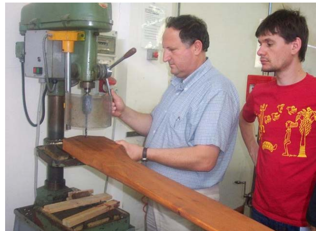
Eseguiamo i fori di fissaggio con il trapano a colonna .....
