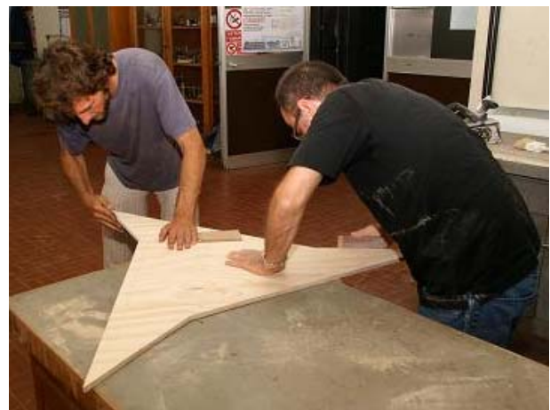
.... e prepariamo, con un foglio di multistrato, il supporto anteriore per tenere insieme le pale.
